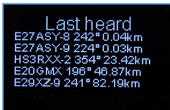
รูปที่ 21 หน้าจอแสดงค่า DISPLAY #3 ข้อมูลสถานีที่รับได้ล่าสุดทาง Rf
