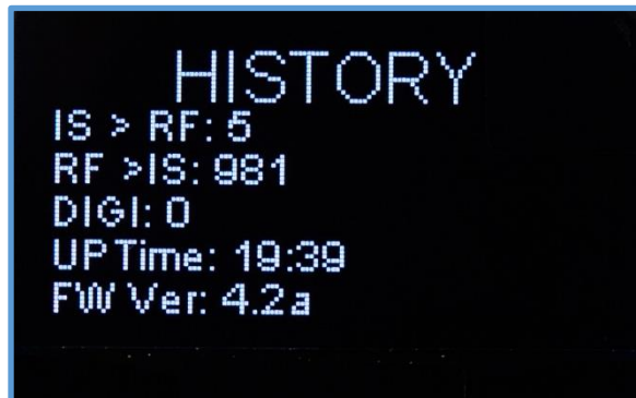
รูปที่ 22 หน้าจอแสดงค่า DISPLAY #4 ข้อมูลสถิติ
