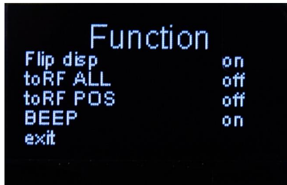
รูปที่ 28 หน้าจอแสดงการตั้งค่า Function (on/off)
