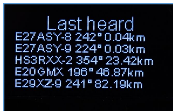
รูปที่ 23 หน้าจอแสดงค่า DISPLAY #3 ข้อมูลสถานีที่รับได้ล่าสุดทาง Rf
